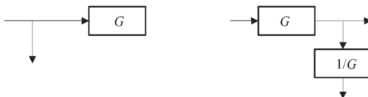
FIGURA 2.5 Relaciones elementales del álgebra de diagrama de bloques
